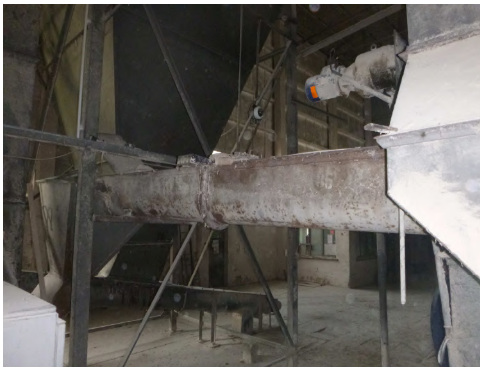
fol. 30 ( podajnik typu ślimakowego o długości 6 m )
